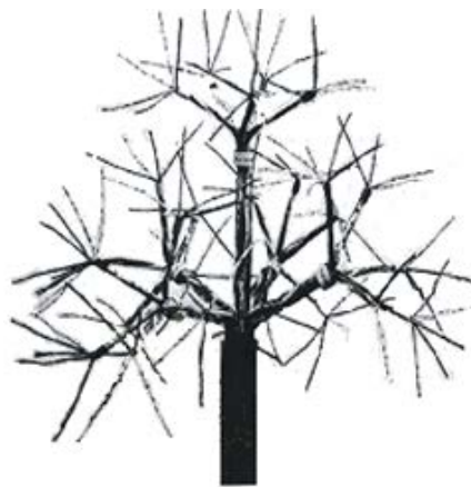
Abbildung 6: Prüfblume an Kabel mit Bündelverseilung
